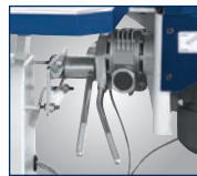
Schleifaggregat über Hebel bis 45° schwenkbar
