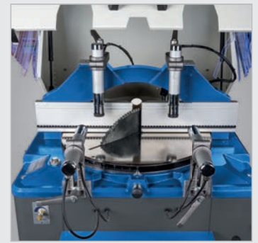
▶ Serienmäßig mit vier pneumatischen Spannzyllindern
