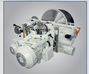
Gusseisen-Sägeaggregat · Massiv, schwingungsfrei mit mehr Laufruhe · Höhenverstellbar und bis +/- 46° schräg verstellbar · Vorritzaggregat mit leistungsstarkem separatem Antriebsmotor · Selbstspannung des Antriebsriemens (SCM Patent)
