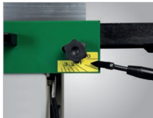
Verstellung der Spanabnahme über Bedienhebel
