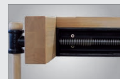
Massive Linearführung an der Hinterzange
