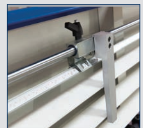
· Lineal zur Längeneinstellung beim Vertikalschnitt
