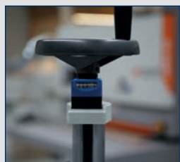
Zählwerk für die präzise Höheneinstellung
