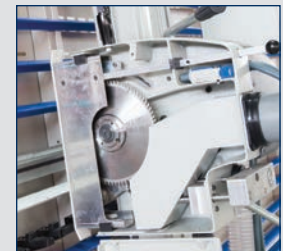
· Große Öffnung für Sägeblattwechsel
