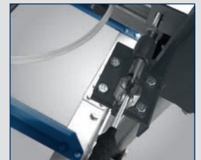
· Beidseitig Feststellhebel für die Arretierung der Schnitthöhe
