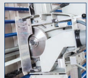
· Große Öffnung für Sägeblattwechsel
