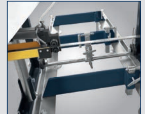
· Verstellbare Sägebandführung für einen präzisen Sägeschnitt
