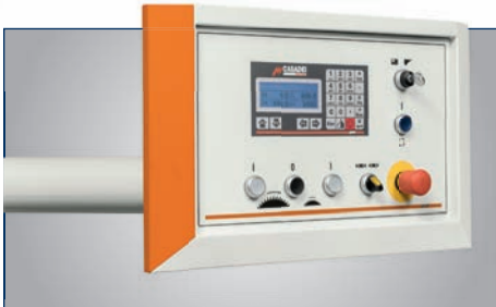
Bedienpult auf Augenhöhe (XENIA 40 MA) ► Einfache und schnelle Einstellungen dank der Steuerbefehle an dem frei hängenden Bedienpult, der in der Ausführung mit angetriebenem Parallelanschlag inbegriffen ist
