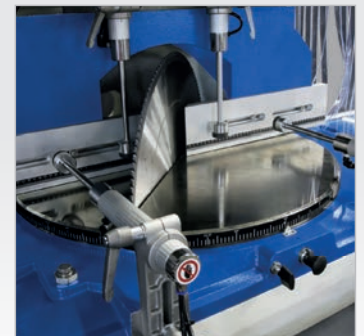
▶ Stufenlose Verstellung des Gehrungswinkels
