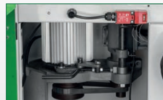
Schnelles und einfaches Wechseln der Drehzahl mittels Vielkeilriemen
