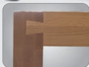
Schwalbenschwanzverzinkung in Hinterzange und Beiladerücken
