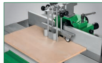
Fräsanschlag mit feineinstellbaren Aluminium-Anschlägen
