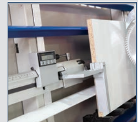
· Digitale Maßanzeige zur Längeneinstellung beim Vertikalschnitt
