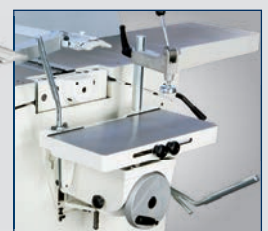
Langlochbohrereinrichtung in Guss-Ausführung Art.-Nr.: 5514500
