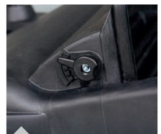
Einfache und werkzeuglose Höhenverstellung der Kehrwalze
